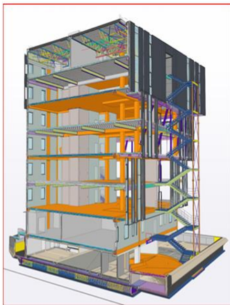
Рисунок 1 – Інформаційна модель будівлі (BIM), що використовується для візуалізації та управління структурними елементами в межах інфраструктурного проєкту
